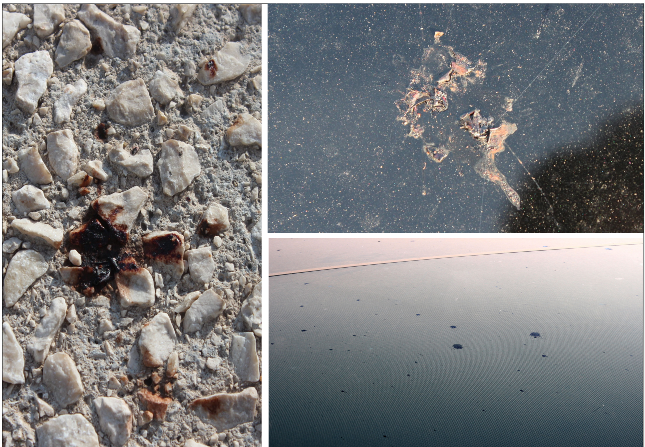
Figure 1. Photographies des retombées observées au sol (gauche), sur un pare-brise (haut-droite), et sur une bâche (bas-droite) sur le site de Distrimag (ZIP de Fos – La Feuillane).
